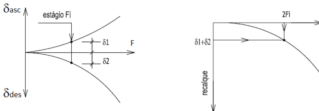
Figura 4. Construção da curva carga-recalque equivalente segundo Cruz (2019).
